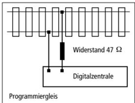
Wenn Sie den Decoder unter dem Lenz, Uhlenbrock oder Arnold-System programmieren, beachten Sie bitte deren Programmieranweisungen. Wenn die Fehlermeldung „err02“ beim Programmieren mit Lenz- oder Arnold-Geräten angezeigt wird, muss ein Widerstand von 47 Ohm (0,5 Watt) in eines der Kabel der Gleisstromversorgung des Programmiergleises eingelötet werden.
