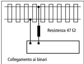
Quando si programma il decoder con centraline Lenz, Uhlenbrock o Arnold, fare sempre riferimento al loro manuale d'uso. Se, durante la programmazione con centraline Lenz o Arnold compare il messaggio "err02", tra uno dei due cavi di alimentazione e il binario di programmazione è necessario inserire una resistenza da 47 ohm ( 0.5 Watt) o superiore.
